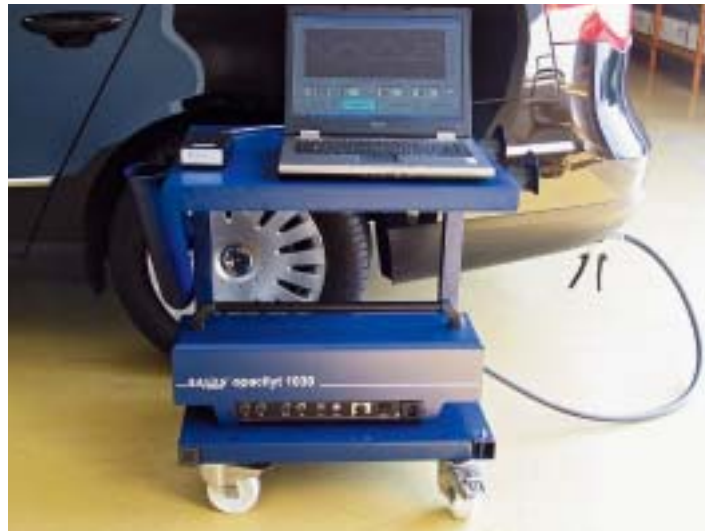
Bei mobil eingesetzten Messsystemen ermöglichen aus Magnesium-Walzhälbezeugen gefertigte Gehäuse und Bauteile nicht nur eine optimale EMI- und RFI-Abschirmung, sondern auch eine Gewichtsreduzierung und Vibrationsdämpfung
